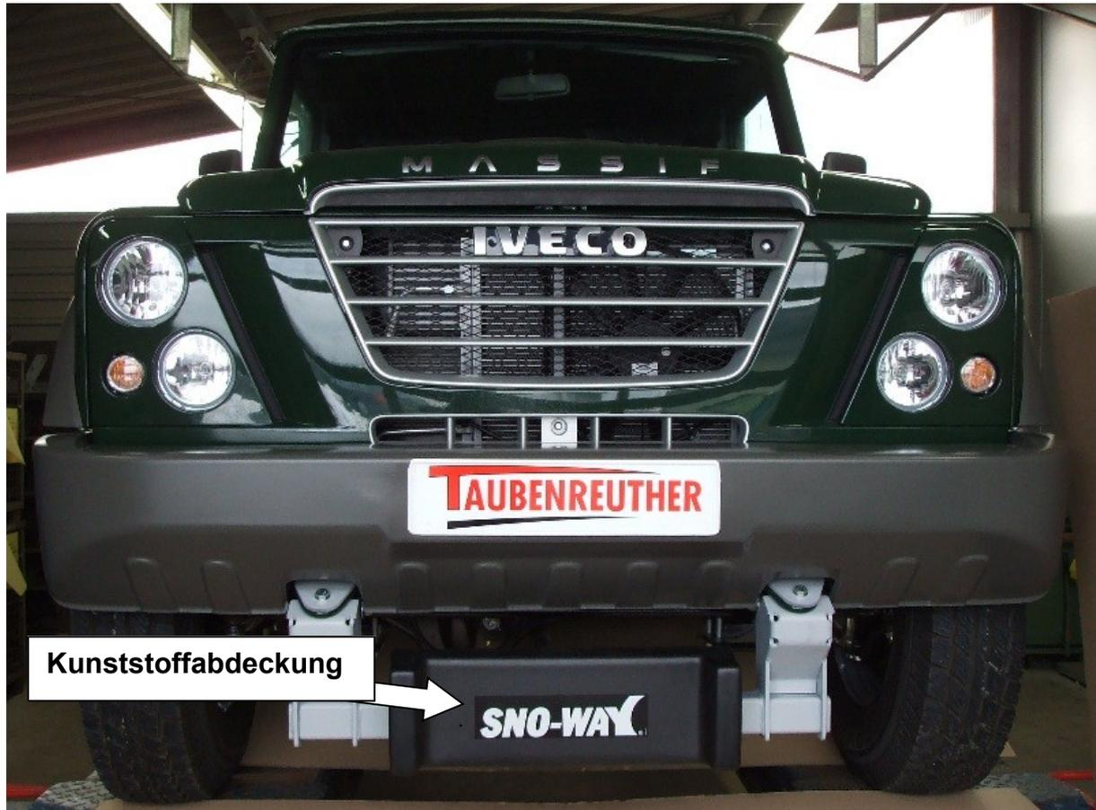
Hier sehen sie den fertig montierten Schneepflugabstützsatz.
